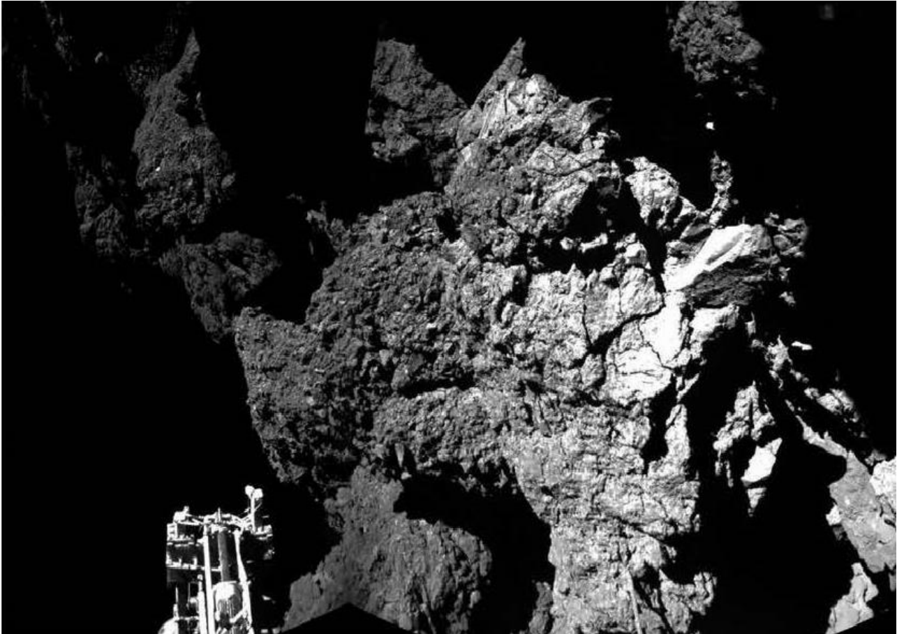
Première image prise à la surface d'un noyau cométaire, après l'atterrissage de Philae/Rosetta sur la comète Churyumov Gerasimenko, le 13 novembre 2014, par l'instrument CIVA, développé sous la responsabilité de l'IAS.
